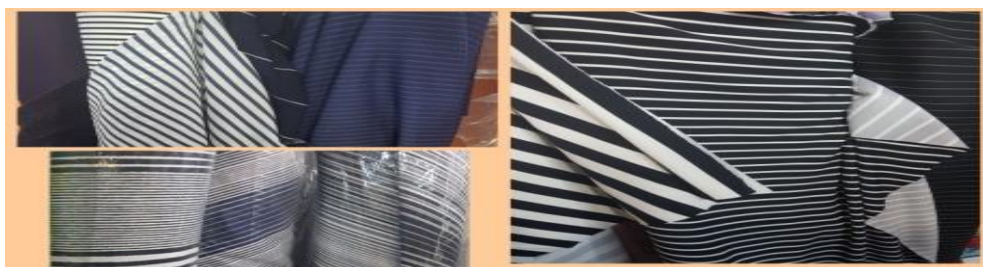
الشكل (6) طباعة الاقمشة المقلمة بالاسطوانات النحاسية، تصوير الباحثة
